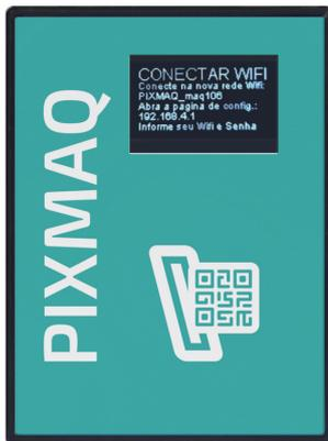
No monitor do micro controlado irá informar o nome da rede Wifi criada pelo equipamento para efetuar a configuração.
