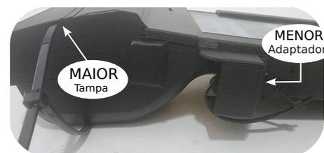
7) Conecte o cabo USB no adaptador e fixe o suporte usando as arruelas e porcas fornecidas.
